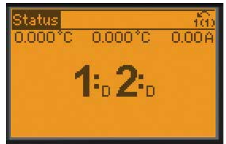
De status van de compressor kan direct op het scherm afgelezen worden. D = Variabele snelheidsregeling, O = Off, R = Netbedrijf, X = Niet actief
