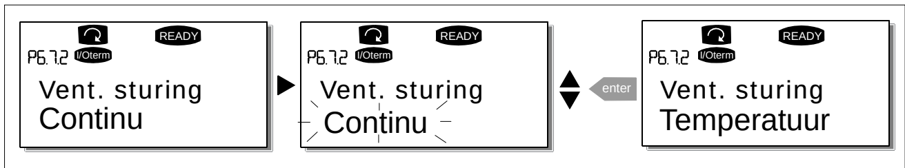
Figuur 7-22. Koelventilator besturingsfunctie
